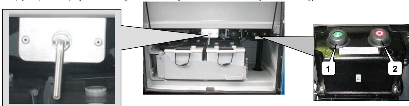
Rys. 15.13. Komora akumulatorów (PNEUBOX): 1 – przycisk awaryjnego włącznika zasilania, 2 - przycisk awaryjnego wyłącznika zasilania, 3 – wyłącznik masy
