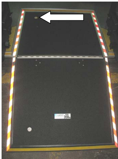
Rys. 20.3. Odchylona rampa – strzałką wskazano czujnik otwarcia rampy
