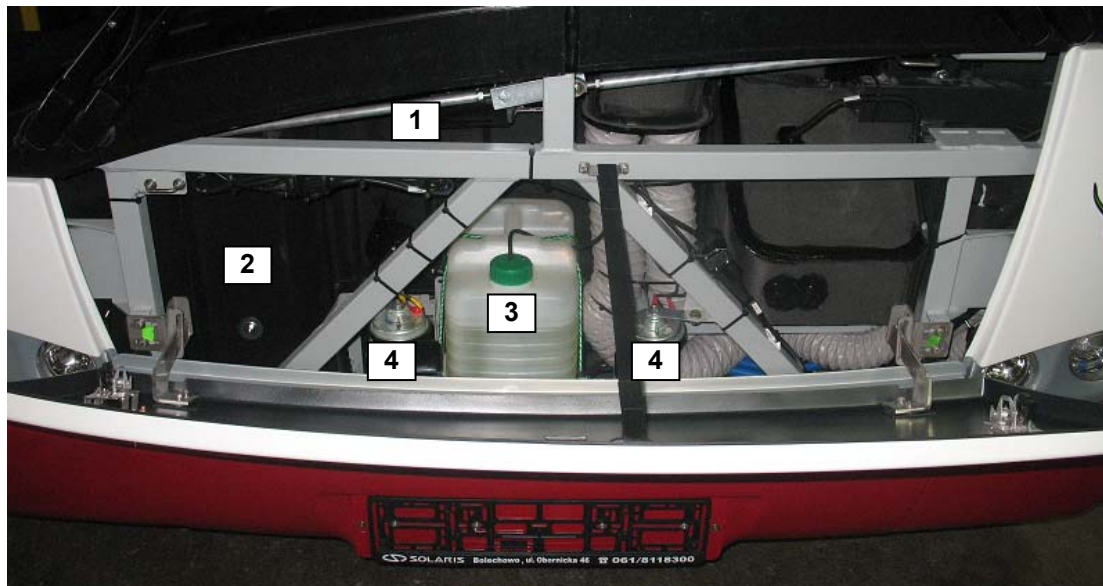
Rys. 15.29. Podzespoły zamontowane z przodu autobusu: 1 - silnik wycieraczek, 2 – pompa płynu spryskiwaczy, 3 - zbiornik płynu spryskiwaczy, 4 - sygnał dźwiękowy
