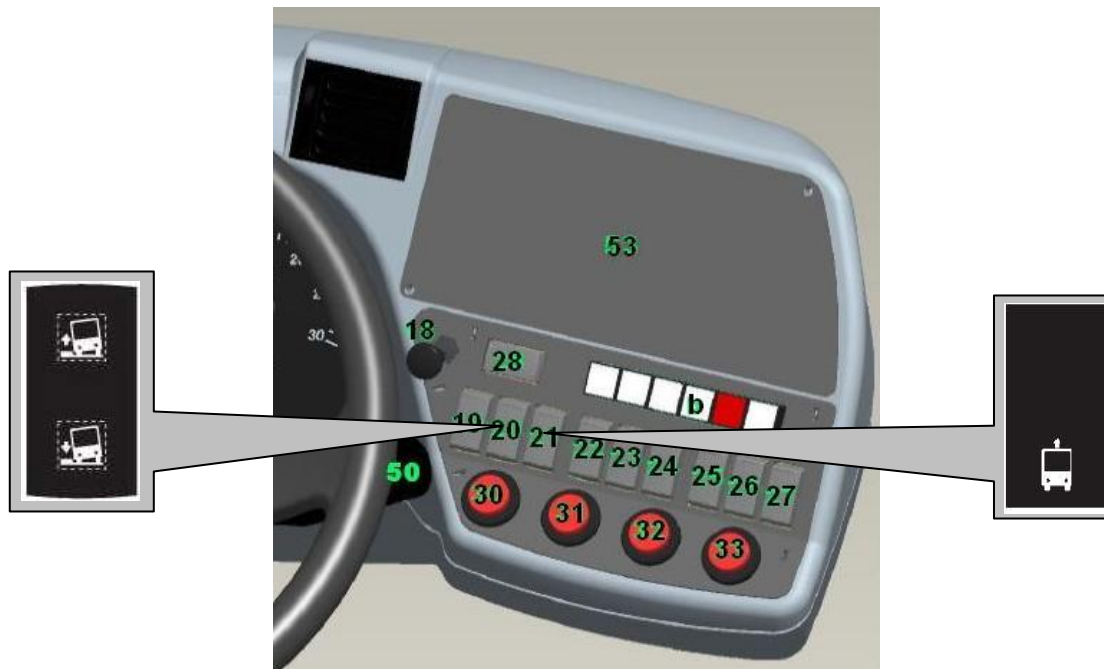
Rys. 10.2. Przyciski związane z zawieszeniem pneumatycznym; 20 – przyklęk, 21 - podnoszenie
