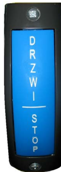
Rys. 24.5b. Przycisk otwierania drzwi po zatrzymaniu się pojazdu
