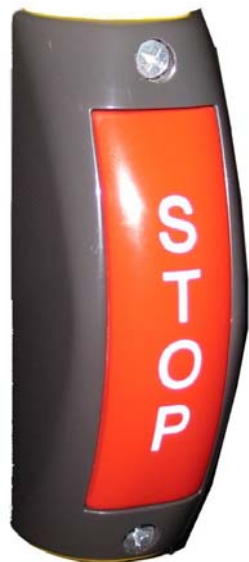
Rys. 24.5a. Przycisk "stop" sygnalizuje kierowcy konieczność zatrzymania się na najbliższym przystanku
